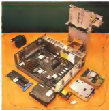
Ed ecco il 50 in pezzi. Per ridurlo in questo stato occorrono solo cinque minuti per mezzo dell'intervento programmazione della macchina. Tutte le parti sono bloccate ed innescate e collegate mediante cerniere e perline.
